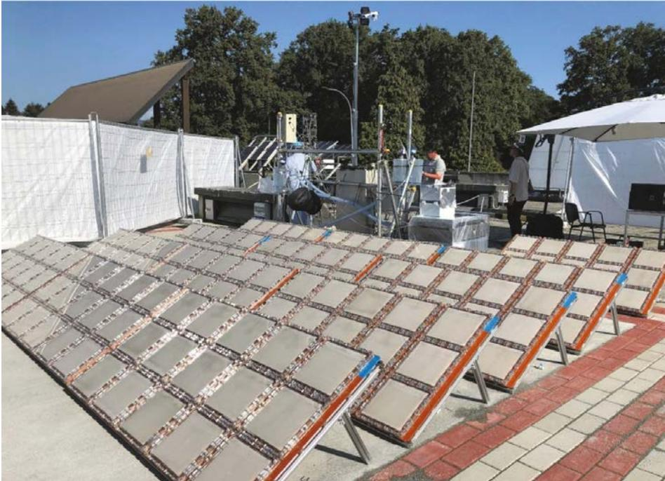
[그림 9] 일본 동경대 K. Domen 교수 연구진에 의해 유럽혁신위원회(European Innovation Council)의 공동연구센터(Joint Research Center, JRC)의 지원으로 이탈리아 Ispra에 설치한 반도체 입자를 이용한 광반응기 면적 12.19 m<sup>2</sup>인 완전물분해 장치의 파일럿 플랜트<sup>16</sup>
